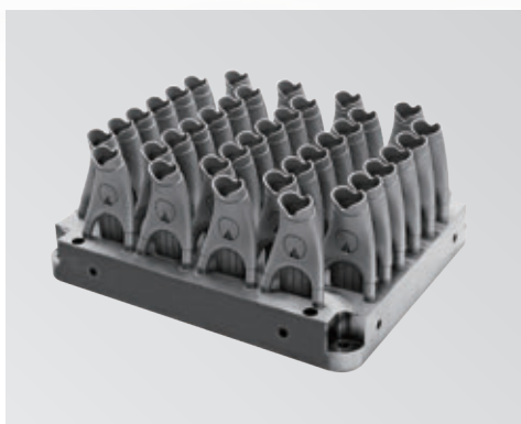
样品名称:自行车后上叉 打印设备:FS350M-4 打印材料:钛合金
